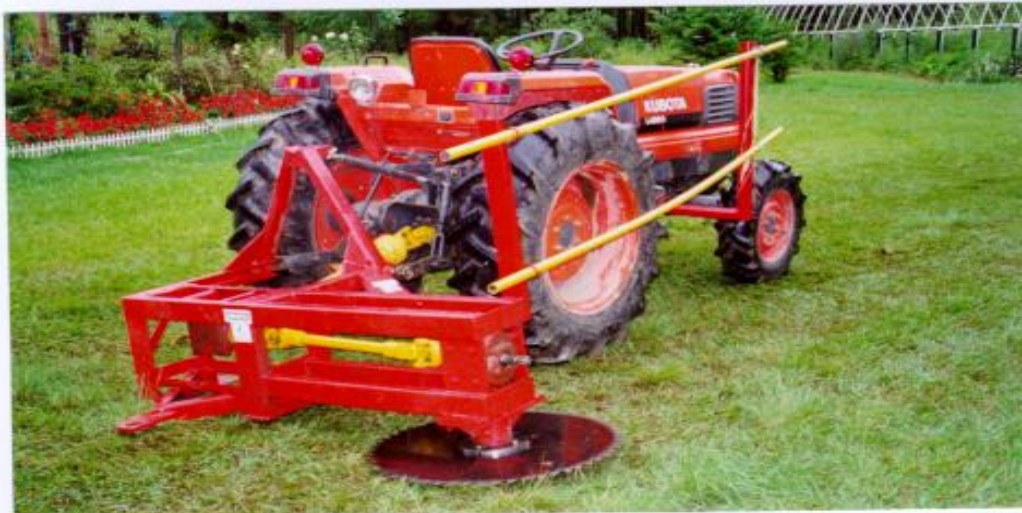
SIERRA CORTADORA DE CAÑA DE AZÚCAR CAPACIDAD DE VOLTEO 8 TONELADAS / HORA. EQUIPO DISEÑADO Y CONSTRUIDO EN CORRIENTES POR LA FUNDACIÓN CINEMA.
